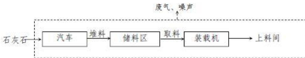
图 2.4-3 白灰料场工艺流程及排污节点图
